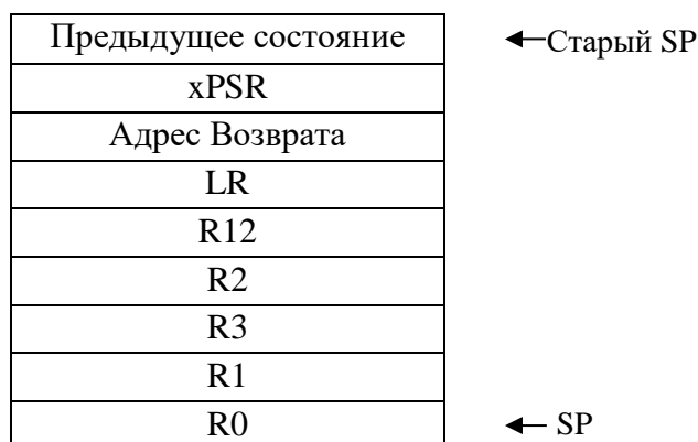
Рисунок 135 – Содержимое стека после того, как исключение прервало обслуживание текущего программного потока
